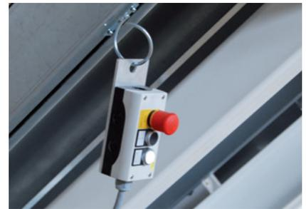
**Подвесной пульт управления (размещается на столе произвольно)**
