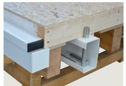
Высокоточная система угловых упоров
