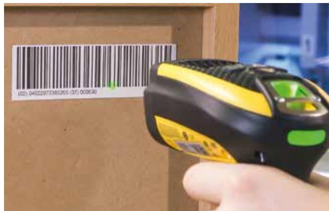
Благодаря **штрихкодовому управлению** ввод данных предельно упрощен. Достаточно сканировать штрих-код — и в систему управления картонорезной машины будут перенесены все данные, необходимые для изготовления упаковки.
