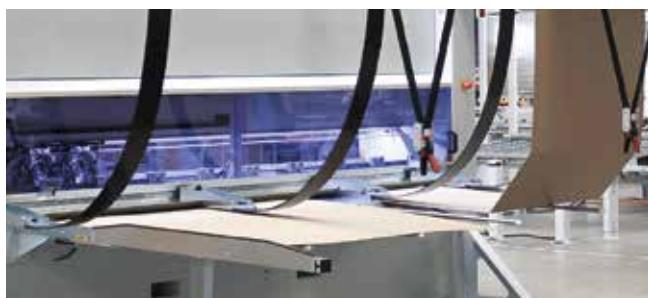
**Комбинированное устройство подачи картона** предлагает возможность использования отдельных листов или бесконечного картона.
