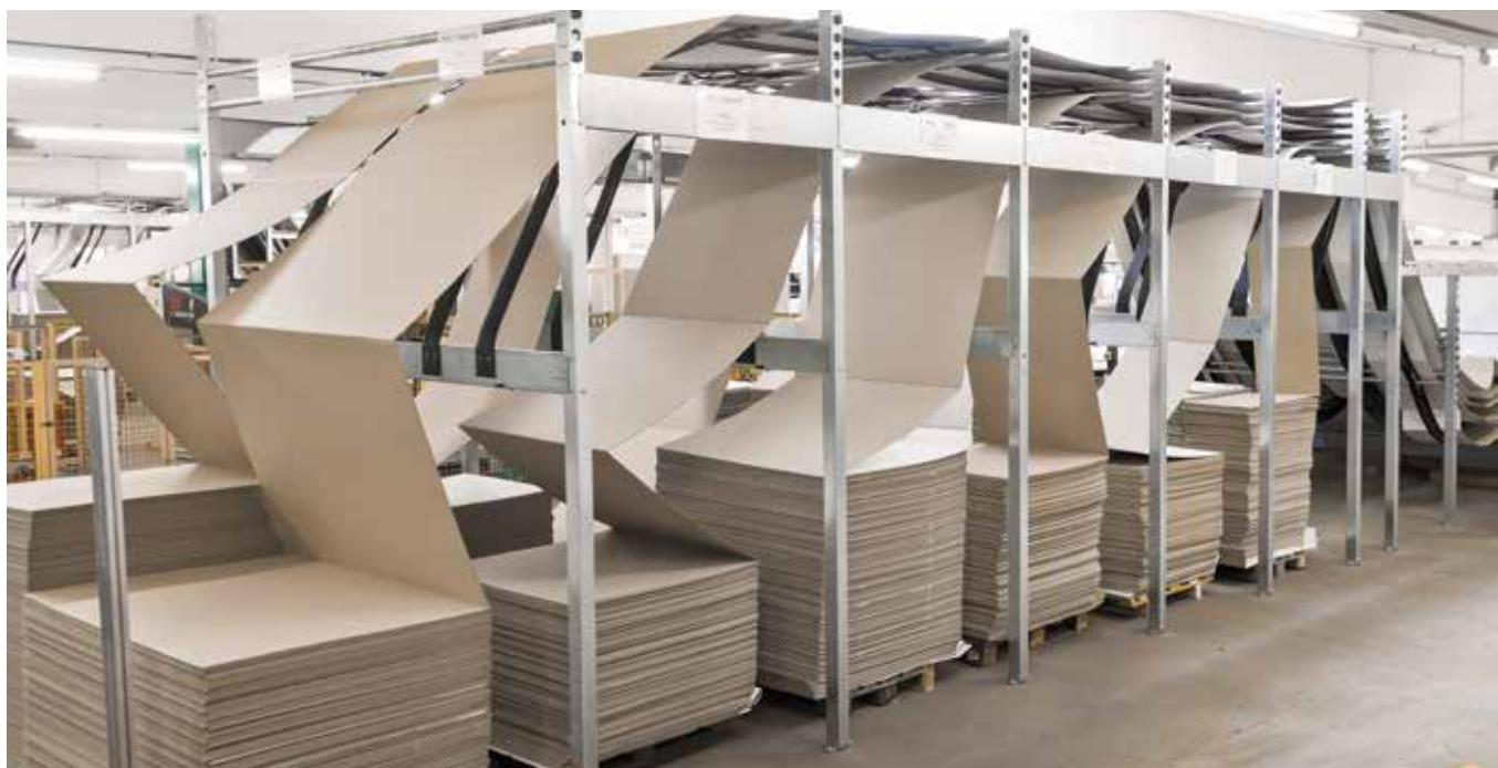
В **параллельном** режиме работы в систему подачи картонных заготовок добавляется еще один параметр ширины, в результате чего в системе на 6 секций может использоваться полотно 12 или менее вариантов ширины.
