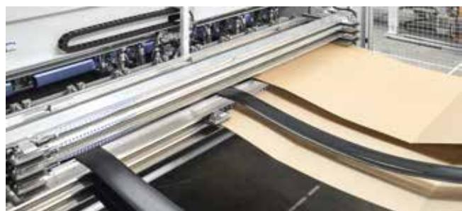
**Устройство смены бесконечного картона** представляет собой автоматическую систему замены непрерывных полотен различной ширины на шесть секций.
