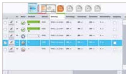
Использование **производственных спецификаций** позволяет автоматизировать изготовление упаковки. Выполнение спецификации можно прервать для изготовления не учтенной в спецификации упаковки, настройки при этом не теряются.
