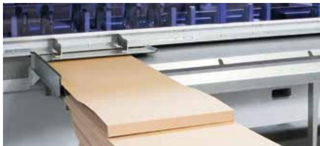
**Устройство подачи отдельных листов** дает возможность загружать в машину как отдельные листы упаковочного картона, так и бесконечный картон — без использования размоточного устройства.
