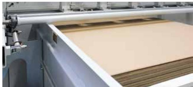
**Автоматическая система подачи листов с подъемным столом** обеспечивает автоматическую подачу уложенных в штабель листов.
