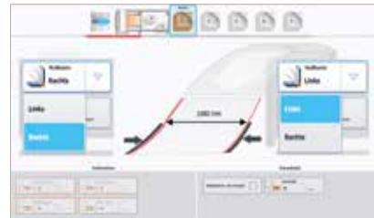
Опция **выбора нулевой кромки** дает возможность выполнять резку с обеих сторон картонорезной машины.
