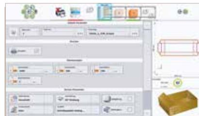
**Система оптимизации раскroя** рассчитывает оптимальное расположение шаблона на бесконечном картонном полотне для минимизации количества отходов.
