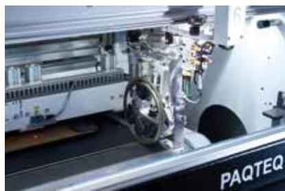
Благодаря **перемещаемым в полностью автоматическом режиме и быстро заменяемым режущим инструментам** возможно выполнение почти любых операций по раскрою.
