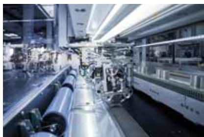
**Инструменты на обрезиненных роликах** позволяют снизить усилие резания и уменьшить износ при сохранении высочайшего качества резания и долгом сроке службы инструментов.
