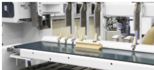
Угловая передача и связь со строгальным станком: конвейерная транспортировка заготовок обеспечивает объединение со строгальным или торцовочным станком.
