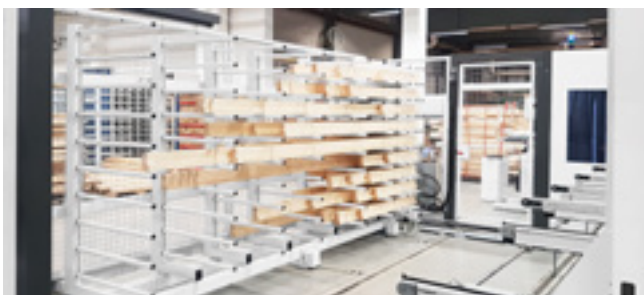
Удлиненный загрузочный/разгрузочный конвейеры: увеличенное время автономной работы из-за увеличенного объема на входе и выходе.
